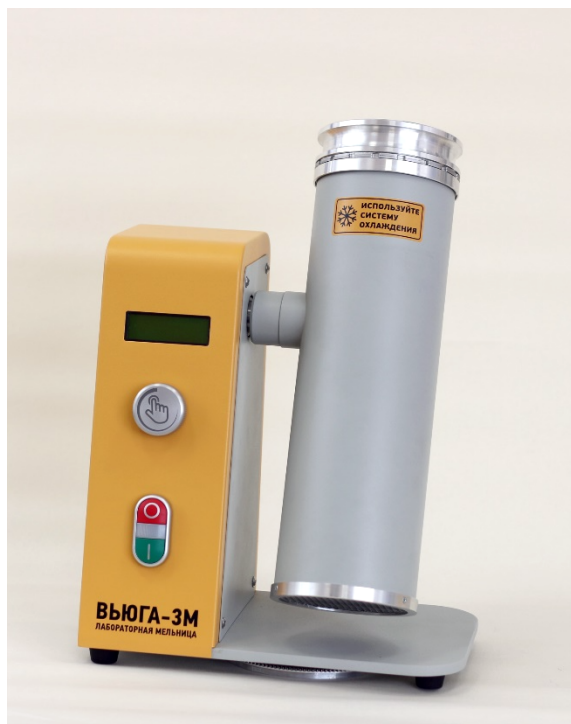
Рис. 4. Положение размольного узла при размоле проб (рабочее положение)
